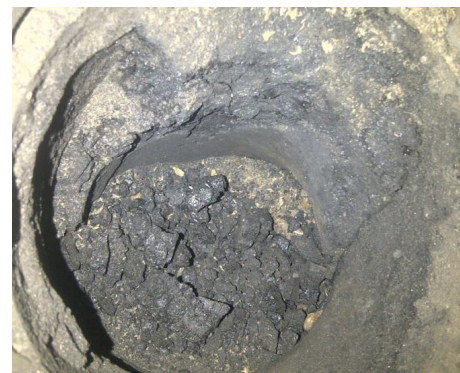
Nagar powstały podczas spalania peletu – widok retorty z góry
