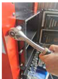
Regulacja rygla zamka (poluzować, ustawić, dokręcić)
