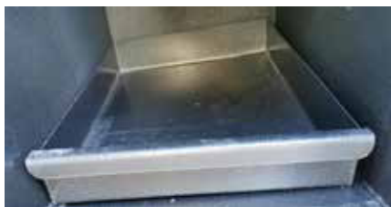
Usuwanie popiołu za pomocą szuflady popielnika
