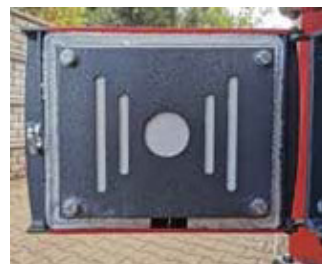
Wymiana uszczelki ceramicznej drzwiczek
